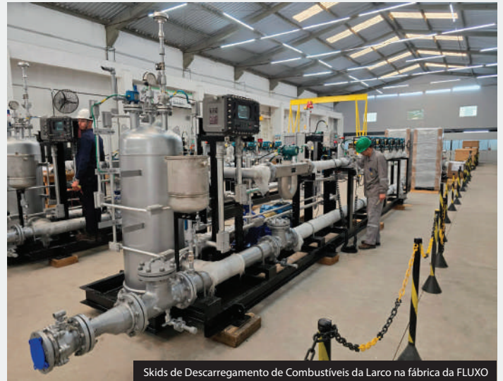
Skids de Descarregamento de Combustíveis da Larco na fábrica da FLUXO
