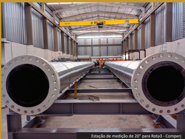
Estação de medição de 20" para Rota3 - Comperj
