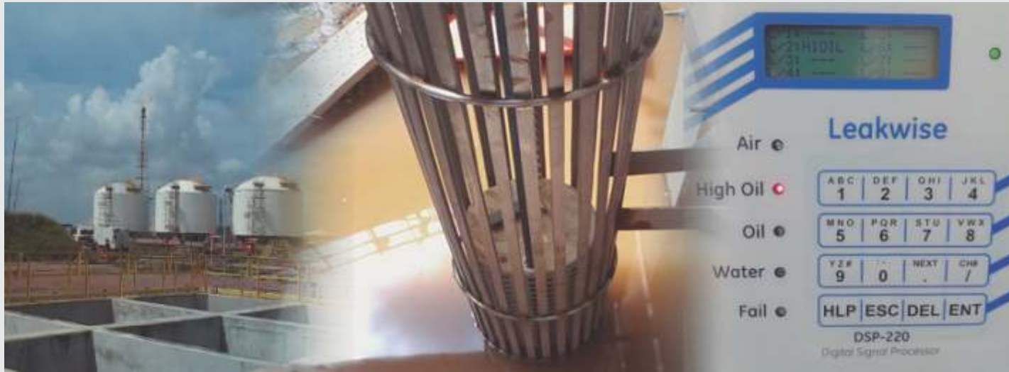
Tanques da Rnest | Tubo acalmador com detector de óleo em água | Visor do processador digital indicando muito hidrocarboneto na água
