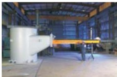
Válvula tipo "slide" (guilhotina) com acionamento hidráulico
