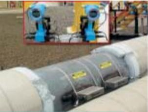
Medidor 1010 PV da Controlotron
